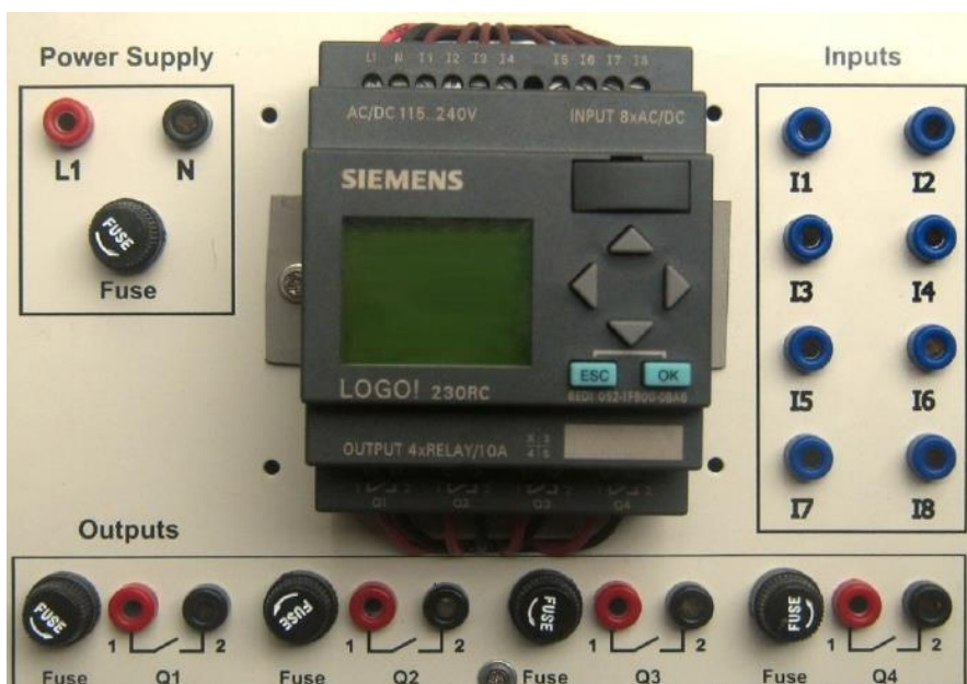
شکل (۲-۳) لوگوی موجود به همراه تغذیه، ورودی‌ها و خروجی‌ها
